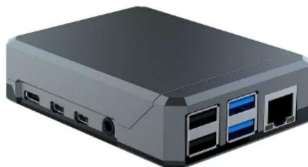
auch habe ich mir für beide pi's ein aluminium (argon case) gehäuse gekauft. für eine passive kühlung. somit gibt es keinerlei geräusche. die temperatur liegt so bei rund 50 grad.
